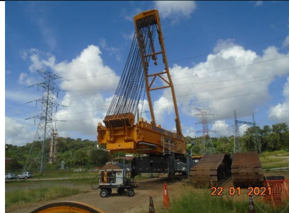
Foto # 4, Grúa 1600/2 – para la descarga del Autotransformador T1.
