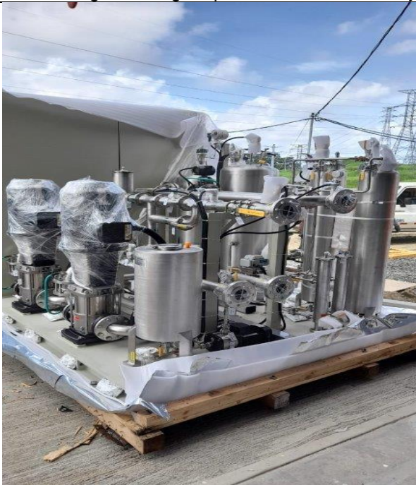
Foto # 7 Suministro del sistema de Water Cooling
