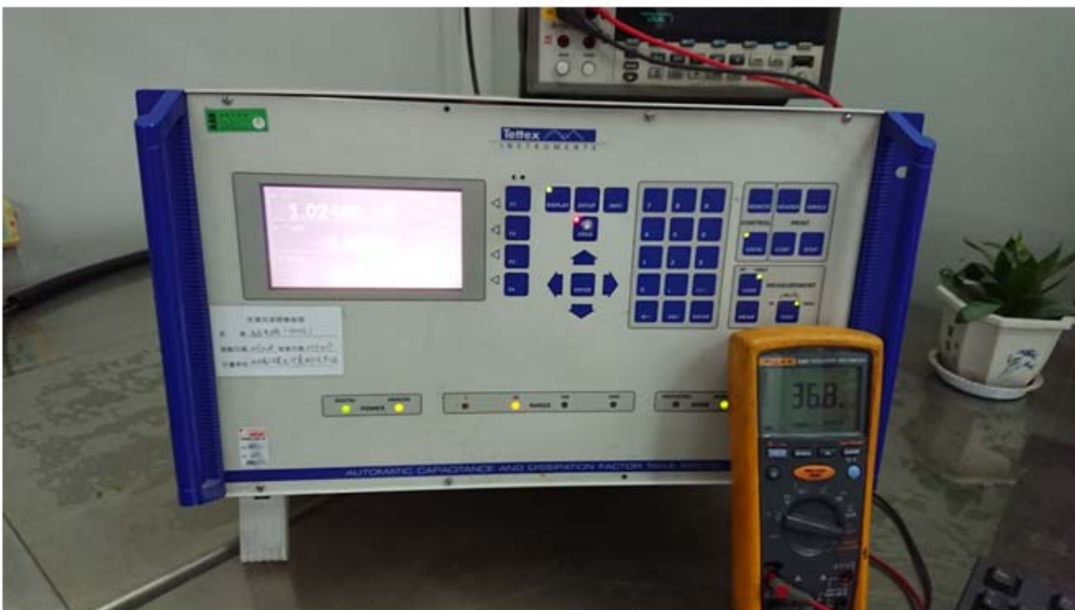
Obtención de datos de las pruebas en fábrica. Proceso de medición de la resistencia interna, el valor obtenido "36.8" están dentro del rango recomendado para este tipo de prueba ( \pm 5\% ).
