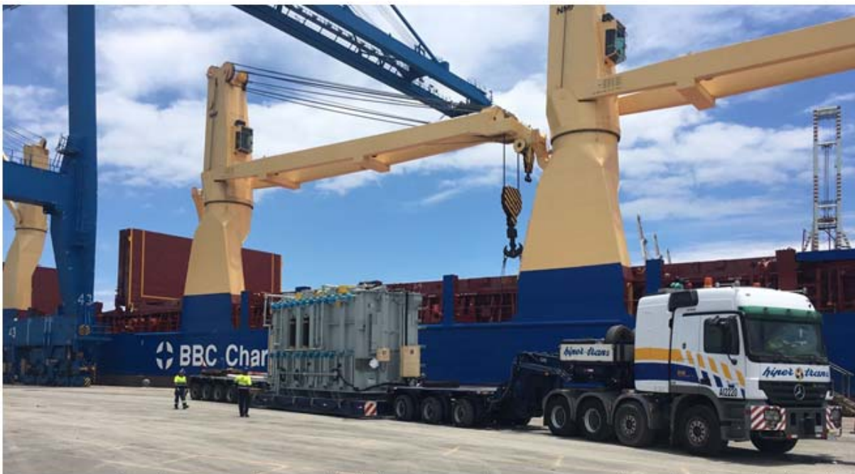
Autotransformador T2 cargado en su vehículo de transporte y listo para ser movilizado a la subestación Llano Sánchez.
