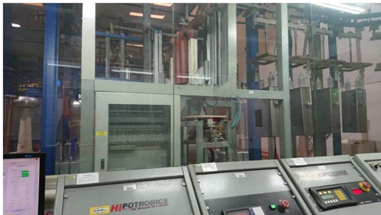
Pruebas realizadas a las pastillas de los bancos de capacitores, ABB China.
