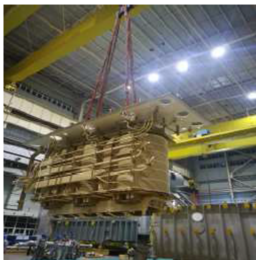
Imagen 3. Transporte de las partes activas con la cubierta
