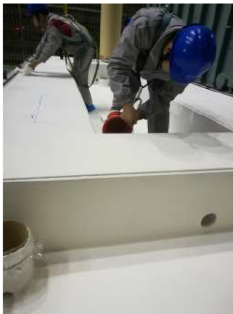
Imagen 2. Resina epóxica para fijar las partes activas a la base
