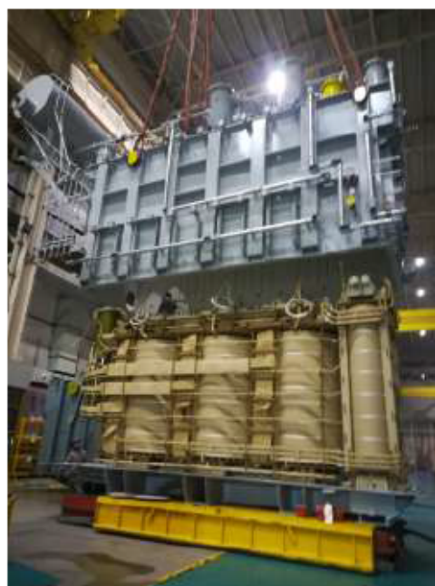
Imagen 4. Colocación de la parte superior de la cuba
