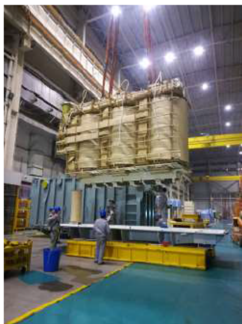
Imagen 3. Transporte de partes activas hacia la base de la cuba
