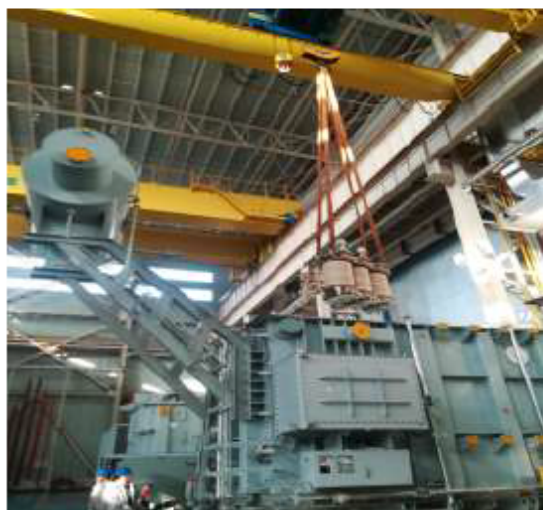
Imagen 1. Inicio del proceso de inserción en la cuba
